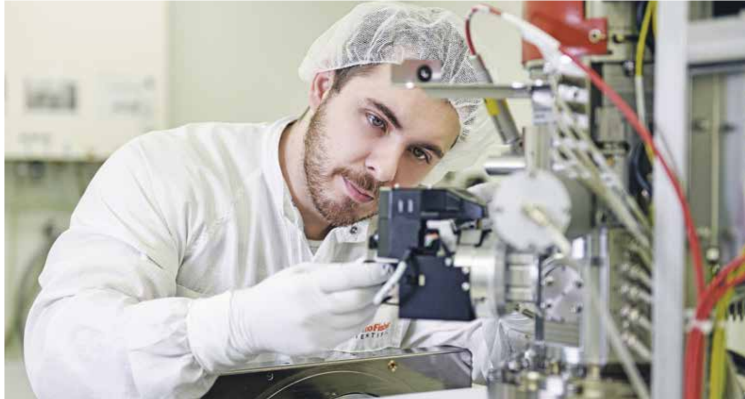
Montáž elektronových mikroskopů probíhá v tzv. čisté místnosti, čímž se zamezí kontaminaci přístroje zrnky prachu. Foto: Thermo Fisher Scientific
